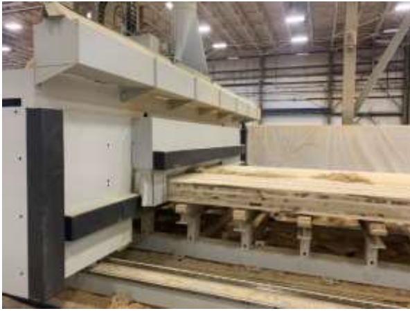
Figura 6. Maquina en CNC sobre paneles CLT
