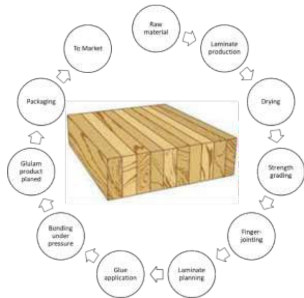
Figura 1. Manufactura de glulam. Adoptado de (Swedish Wood, 2021) Fuente del diagrama: (Naturally Wood, 2021).
