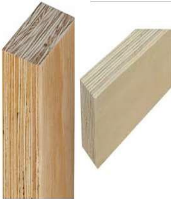
Figura 2: Madera de chapa laminada (LVL) (Chirag Enterprises, 2021; CWC, 2021a).
