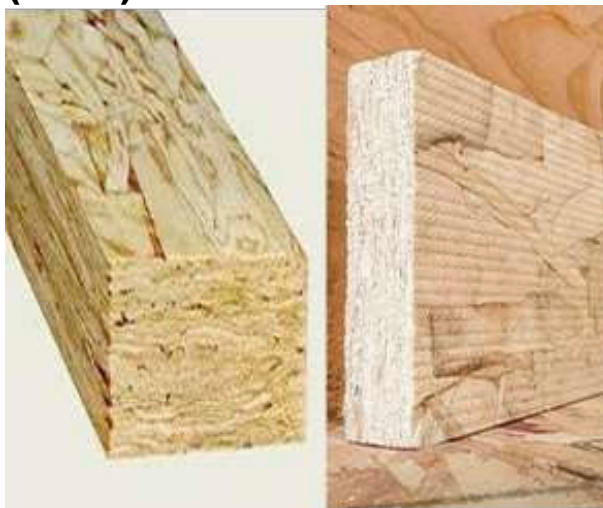
Figura 4: Madera de fibra orientada (OSL).(CWC, 2021c; Intense Research, 2021).
